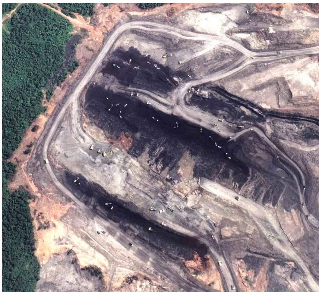
Рис. 1. Фрагмент космоснимка открытых горных работ на угленасыщенном участке месторождения с тремя мощными пластами крутонаклонного залегания
