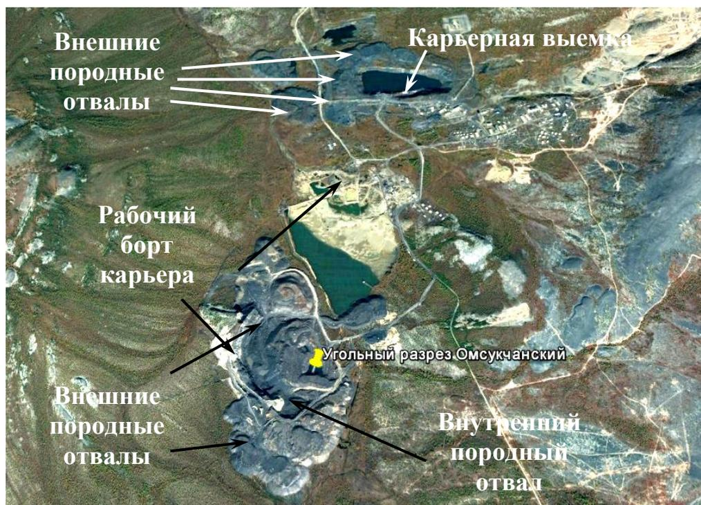
**Рис. 4. Компоновочная схема горных работ на разрезе «Омсукчанский»**
