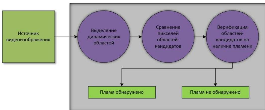
Рис. 1. Структурная схема алгоритма обнаружения пламени
