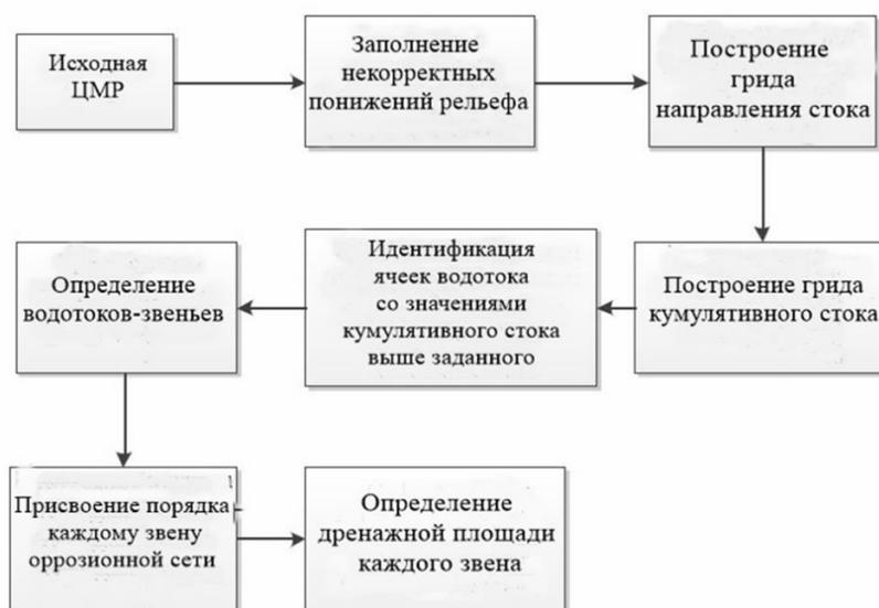
**Рис. 1. Алгоритм определения водосборного бассейна реки**
